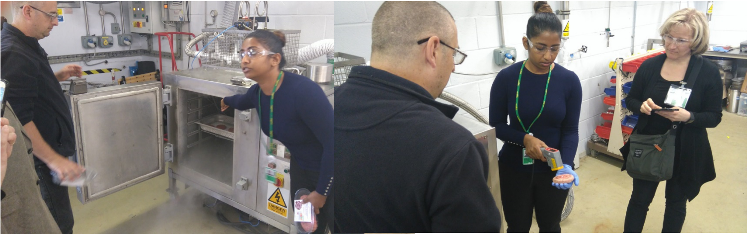
Kuva X. Demonstraatio 2. Jauhelihapihvin esijäähdyttäminen tunnelissa. Vasemmalla Air Productsin nestetypellä toimiva koelaitteisto, oikealla pihvin pintalämpötilan määrittäminen esikäsittelyn jälkeen (Kuva Henri Vanhanen/LUKE).
