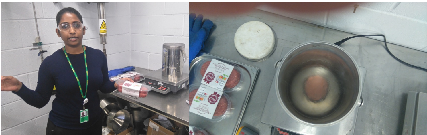
Kuva X. Demonstraatio 1. Jauhelihapihvin pakastamisen nestetyypen kulutus. Vasemmalla Air Productsin tutkija esittelee tuotteen ja mittauslaitteiston, oikealla pihvi upotettuna nestetyypeen (Kuva Henri Vanhanen/LUKE). Demo 2
